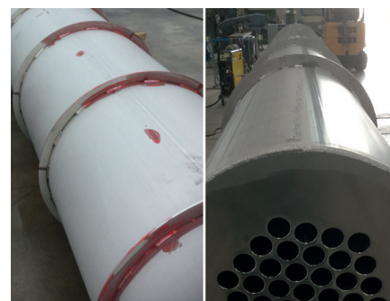
Fotografie ukazuje použití RedOne™ mořící pasty 140 u vysoce legovaného výměníku tepla 2205 (1.4462) při nízké teplotě (+8 °C).
